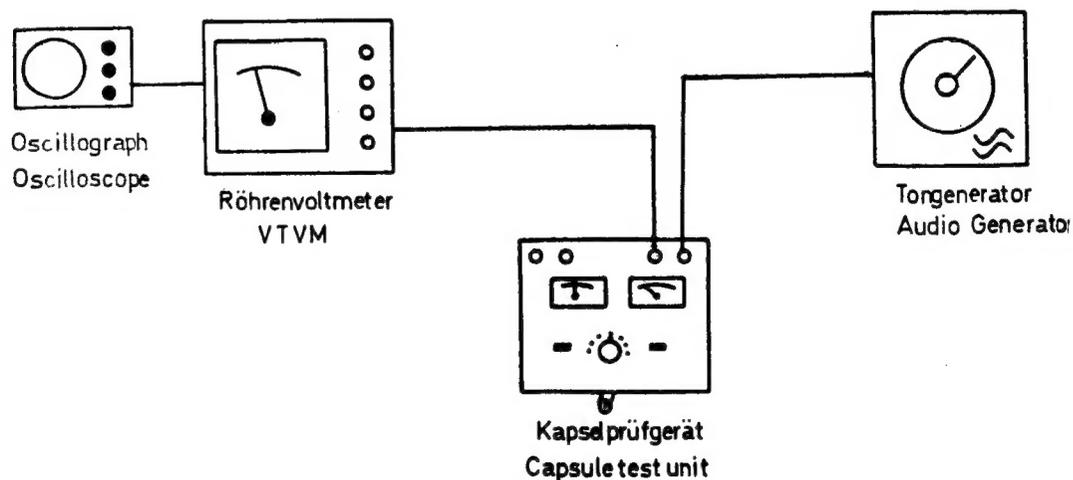
Abb. 2 Meßaufbau: Kapselprüfgerät
