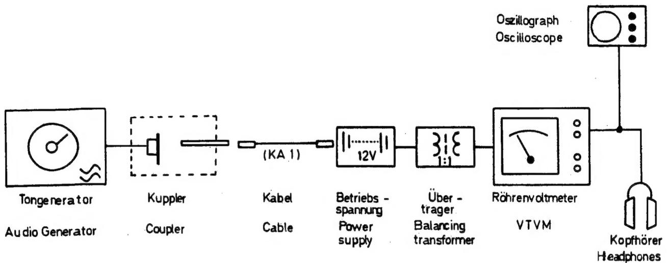
Abb. 1 Meßaufbau: Funktionsprüfung mit Kuppler
